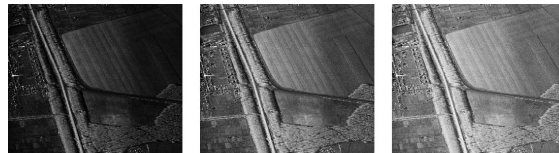
Рисунок 3.18 - Применение логарифмического преобразования к РЛИ
